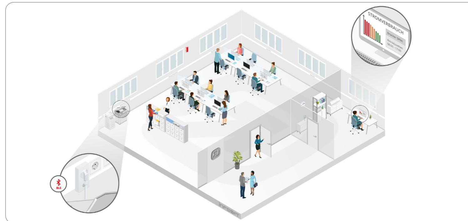
Energiemonitoring und -steuerung via BLE Steckdose
