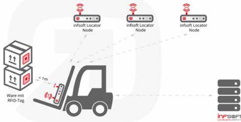
Kombination von RFID und UWB für die Identifikation und Verortung von Waren
